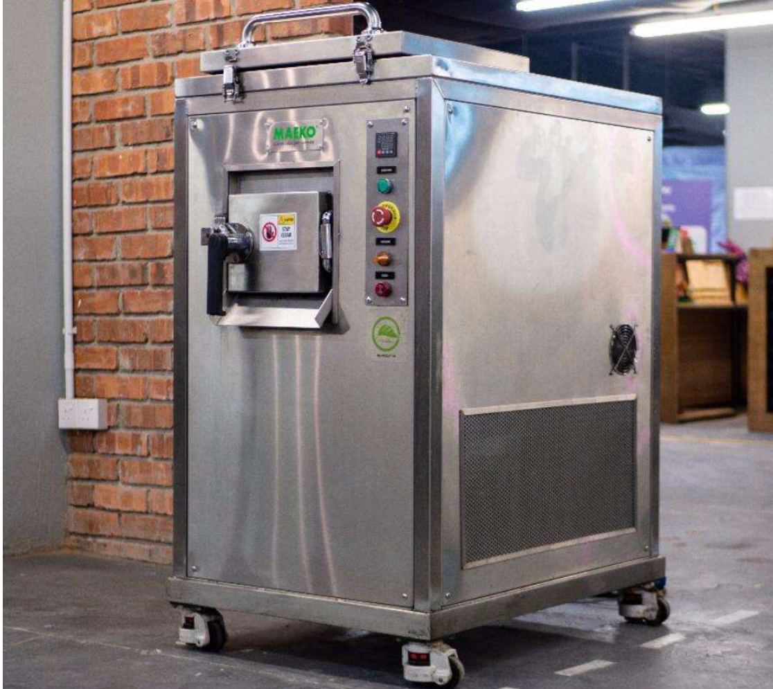
Depósito para fabricar abono a escala industrial. Crédito de la foto: Maeko
