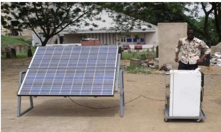
Experimentación de un frigorífico de compresión de vapor alimentado por energía solar fotovoltaica en Nigeria. Crédito de la foto: [86]
